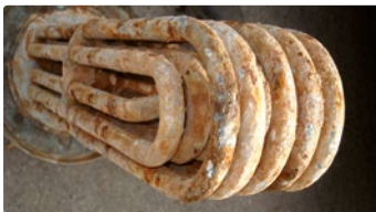
Tubería de un intercambiador de calor
