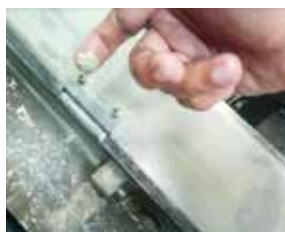
13 de junio: En la máquina 2 con Vulcan durante 1 mes, la cal se ha disuelto y se puede quitar con el dedo.
