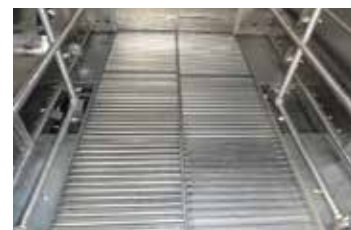
Arandela de rejilla de acero inoxidable ya completamente libre de cal
