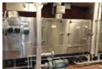
Arandela de rejilla de acero inoxidable ya completamente libre de cal
